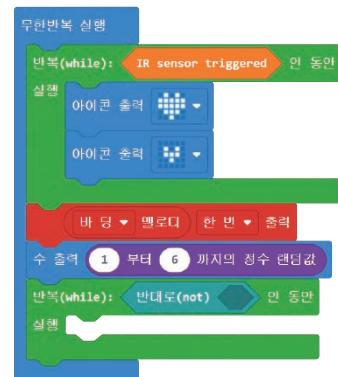
Step 9 [ IR Bit ] 카테고리를 클릭하고 [ IR sensor triggered ] 블록을 선택합니다.
